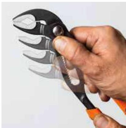
Un autre mécanisme breveté de réglage rapide est disponible pour notre gamme 722X et permet un fonctionnement très intuitif. Tournez simplement le bouton pour ouvrir les mâchoires. Pour fermer les mâchoires, vous pouvez simplement fermer les poignées sans utiliser à nouveau le bouton.
